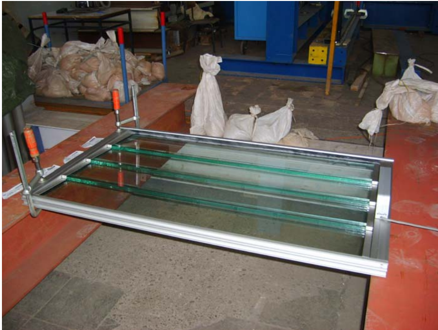
Gesamtansicht des Prüfelements zur Prüfung der Windsoglasten
