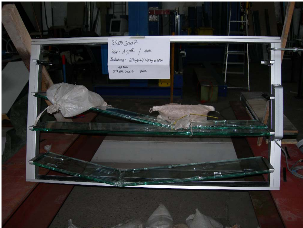
Versagen von Scheibe 2 nach einer Standzeit zwischen 4,5 und 19 Stunden Glasscheibe fällt nicht zu Boden
