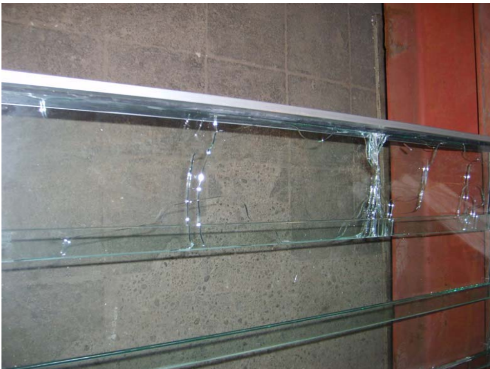
Bruchbild Scheibe 4 nach Abbruch der Versuche
