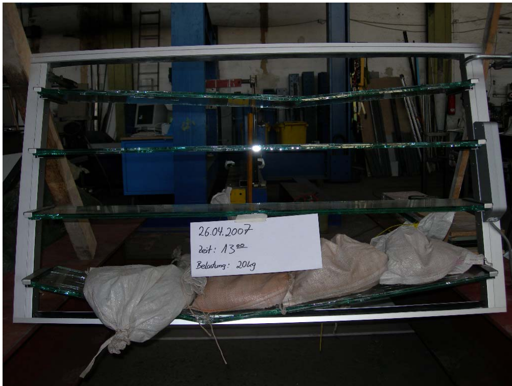
Scheibe 2 und 4 nach einer Standzeit von 24 Stunden
