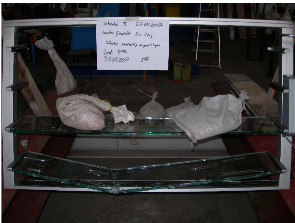
Scheibe 3 nach einer Standzeit von 72 Stunden
