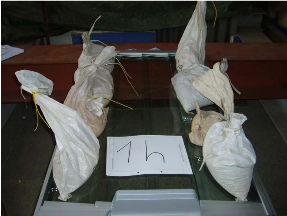
Scheiben 1 und 4 nach einer Standzeit von einer Stunde unter einer Flächenlast von 112 \text{ kg/m}^2
