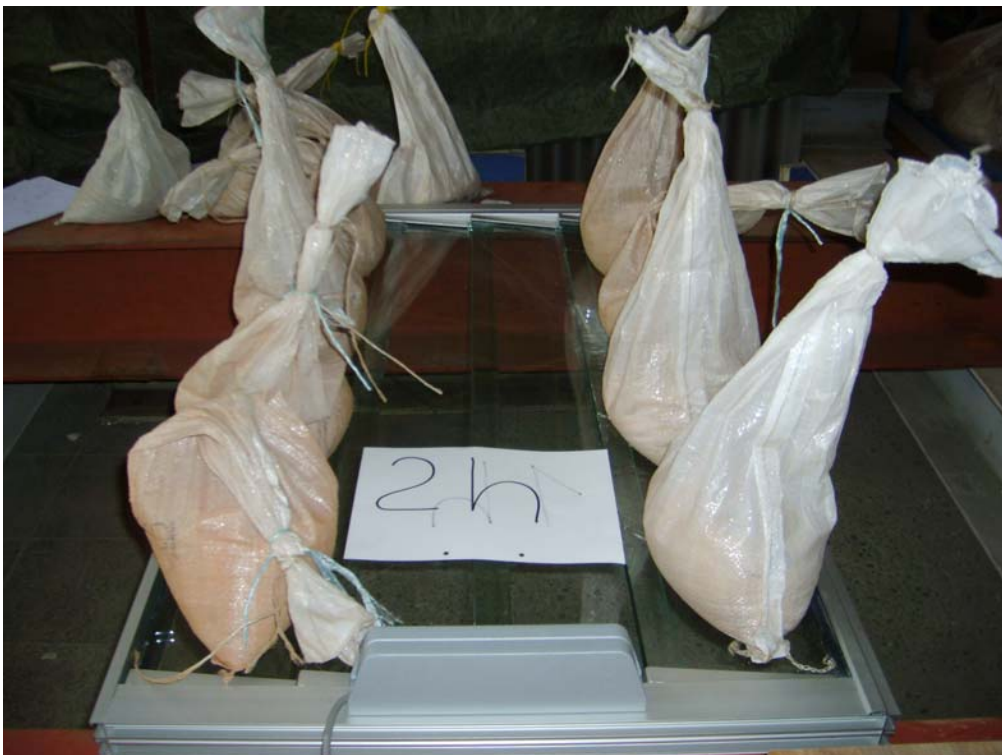
Scheiben 1 und 4 nach einer Standzeit von 2 Stunden unter einer Flächenlast von 216 \text{ kg/m}^2
