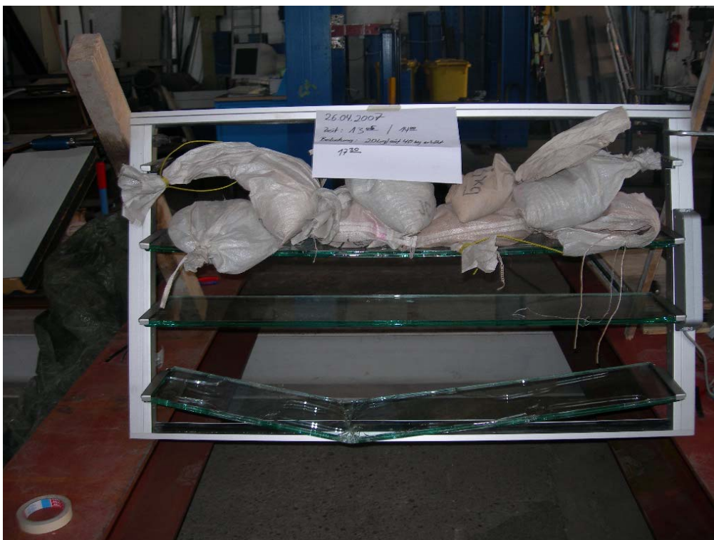
Scheibe 2 nach einer Standzeit von ca. 4,5 Stunden unter 186 kg/m 2
