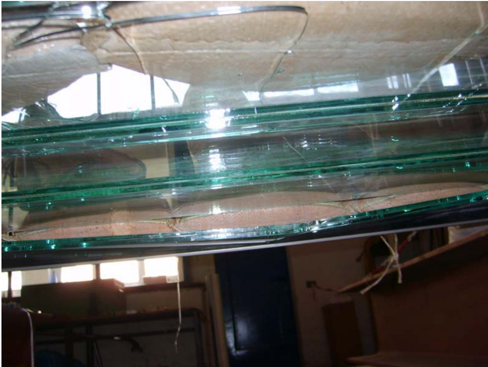
Untersicht Scheiben 1 und 4 nach einer Standzeit von 24 Stunden unter einer Flächenlast von 216 \text{ kg/m}^2
